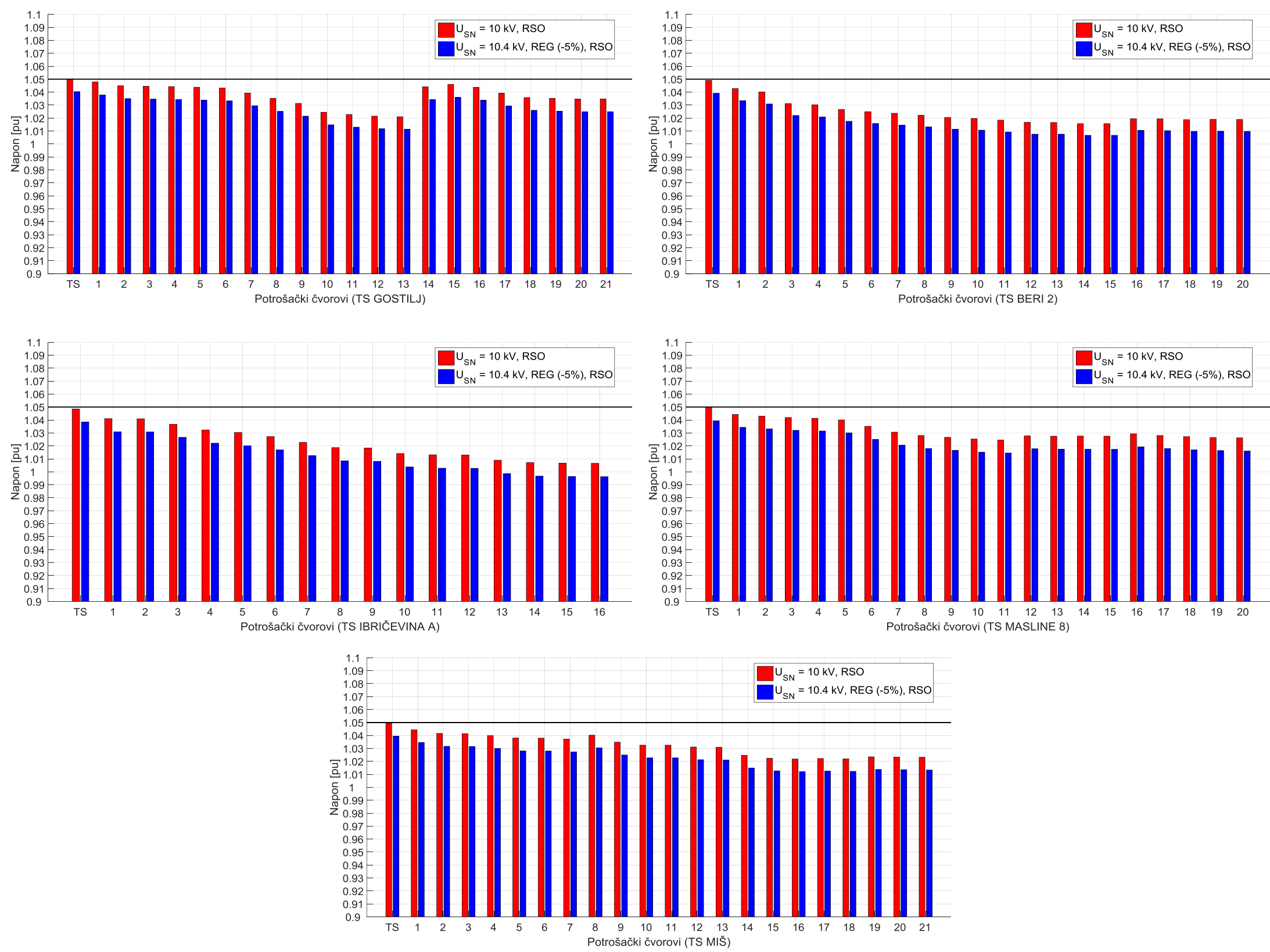
Slika C.1: Upoređivanje vrijednosti napona u potrošačkim čvorovima posmatranih pet NN izvoda za pogonske uslove EDM: napon na SN strani je 10 kV pri RSO i napon na SN strani je 10.4 kV pri RSO i regulaciji – 5%
